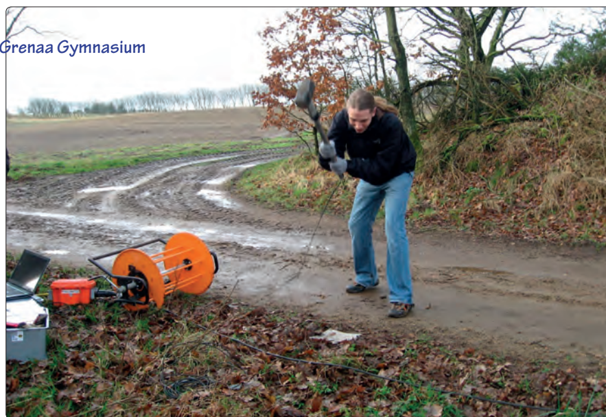
Figur 1 Hammerseismik-udstyr i felten.
