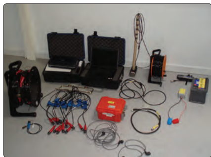
Figur 3 Den seismiske udstyrspakke til udlån.
