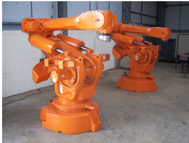
Figur 1.1: En typisk industrirobot som denne består af en række led der hver især kan bøjes eller roteres på forskellig vis.
